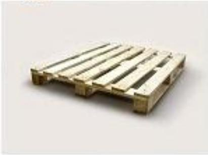
Настил поддона сконструирован из 7 обрезных досок толщиной 20-25 мм., расстояние между которыми менее 85 мм. Ширина поперечной доски не менее 100 мм. Размерность «шашек» не менее 100 мм. по длине, 80 мм. по ширине. Допускаются «шашки» только прямоугольного сечения.
